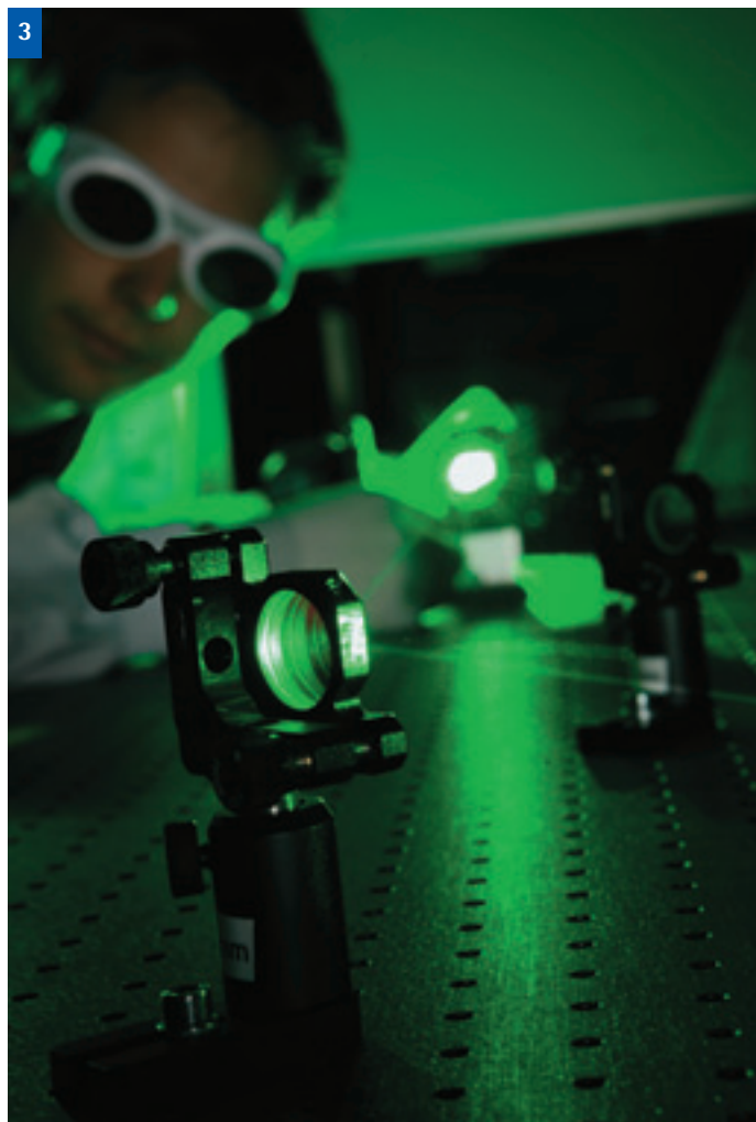
Abbildung 3 Ein Mitarbeiter justiert das am ISFH entwickelte Picosekunden-Lasersystem. Der Einsatz moderner Lasertechnologie erlaubt die berührungslose Herstellung hocheffizienter Solarzellen auch aus sehr dünnen Siliciumscheiben (< 150 Mikrometer). Quelle: ISFH
