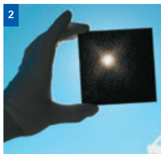
Abbildung 2 Rückseitenkontaktierte Hocheffizienzsolarzelle. Die mittels Laser erzeugten Löcher in der Solarzelle erlauben die Verwendung von kostengünstigem Siliciummaterial mittelmäßiger Qualität. Die gezeigte Solarzelle befindet sich derzeit in der Überführung in eine industrielle Pilotproduktion. Quelle: ISFH
