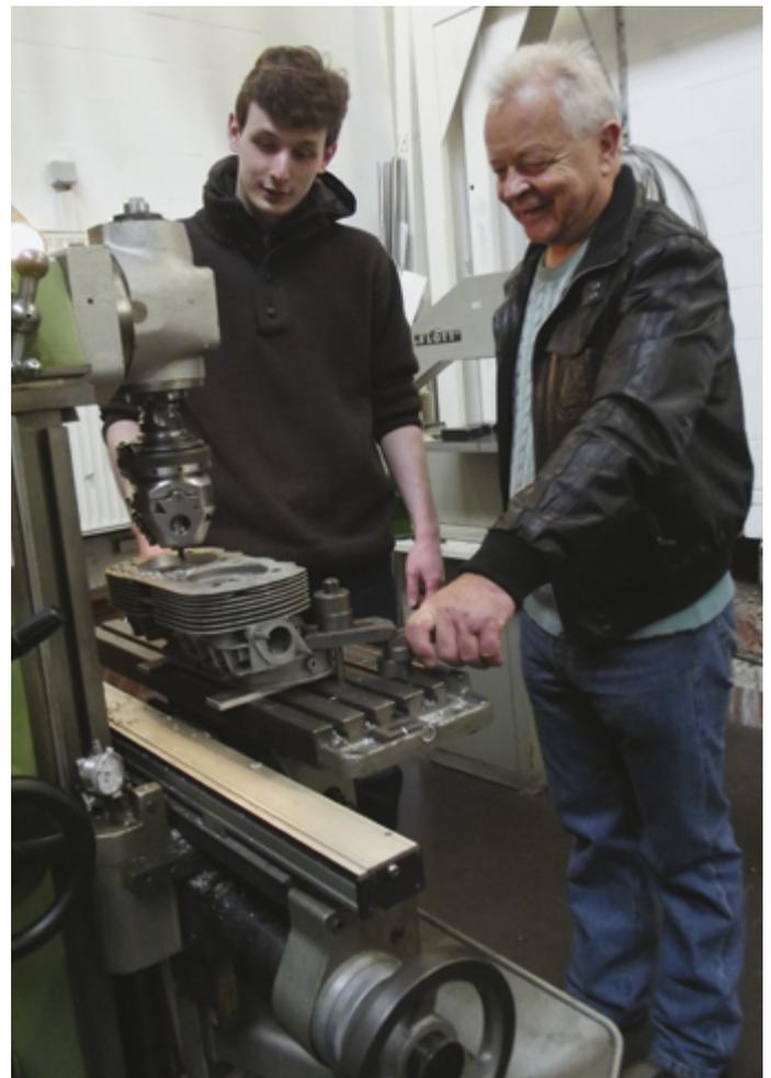
Maschinenbaustudent Christian Seefisch und Ingenieur Knut Milbradt an der Fräse, die vom Institut für Materialien und Bauelemente der Elektronik ausgemustert und bei Akakraft auf CNC Maschinensteuerung umgerüstet wurde.
