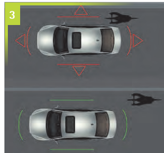
Abbildung 3 Konzept zur Lichtkommunikation autonomer Fahrzeuge Quelle: Institut für Produktentwicklung und Gerätebau
