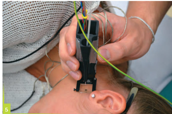
Abbildung 4 Der kombinierte OCT-Raman-Kopf bietet die Möglichkeit beide Messungen schnell hintereinander durchzuführen. So kann sichergestellt werden, dass dieselbe Hautstelle vermessen wurde.
