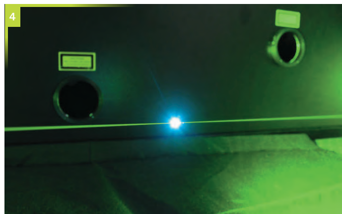
Abbildung 4 Ein gepulster Laserstrahl wird in der Luft fokussiert. Seine Intensität ist so groß, dass die Luftmoleküle auseinandergerissen werden. Die schnelle Bewegung der Elektronen erzeugt einen hellen Blitz. Quelle: Institut für Quantenoptik
