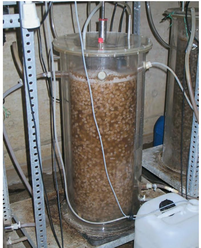
Versuchsreaktor zur Erprobung der Deammonifikation, einem innovativem Verfahren zur Stickstoffelimination. • Foto: ISAH
