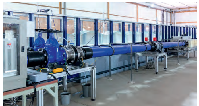
Das Forschungszentrum Küste in Hannover-Marienwerder startet einen Modell-Wellenkanal. Das Modell im Maßstab 1:10 ist ein Nachbau des Großen Wellenkanals in seiner künftigen Ausbaustufe. Foto: Michael Matthey, LUH
