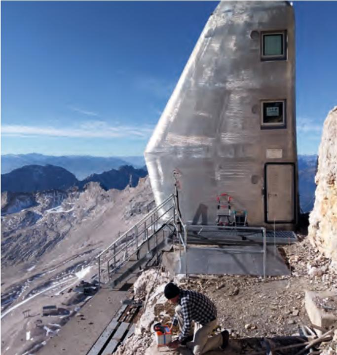
*Das dreigeschossige ZUGOG im Sommer 2018 bei „Kaiserwetter“. Das gute Wetter nutzte Ludger Timmen für die geodätische Geländeaufnahme und für relativgravimetrische Feldarbeiten im Gipfelbereich (L. Timmen mit einem Relativgravimeter, Aufnahme von Christian Voigt (GFZ) im Oktober 2018)*
