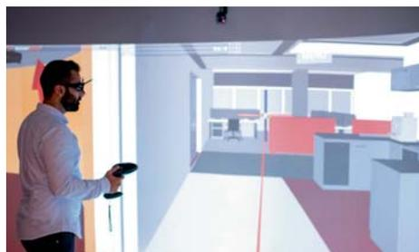
Für die Erforschung der digitalen Methoden bietet das X-Lab zum einen den Curved Space, ein Halbrund mit 6 Metern Durchmesser und interaktiver Wand-/Bodenprojektion, für das virtuelle Erleben von Bauwerken wie Gebäuden und Brücken. Zum anderen kann im Prozess-Simulator die Zusammenarbeit in Bauprojekten realitätsnah durchgespielt und optimiert werden.
