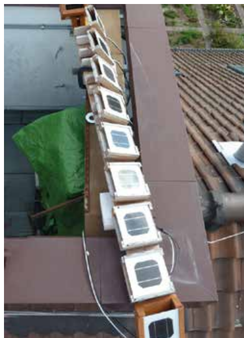
Solarzellen verschiedener Neigung auf dem Dach des Instituts für Meteorologie und Klimatologie in Herrenhausen
